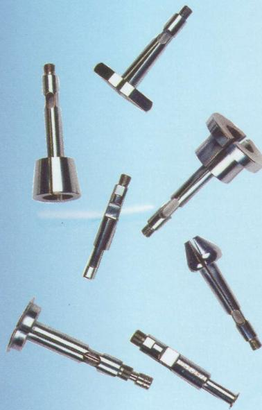
Système de vérificateur d'alésages universel avec cote affichée.
