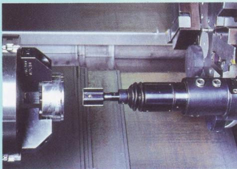
Le support flottant compense des erreurs de positionnement.
